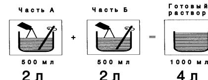
Примечание. При заливке в машины, специально сконструированные для процесса СР-47Л (напр. РР 728), части А и Б не смешиваясь заливаются в отдельные баки, предназначенные для этих частей.
