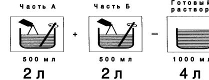
Примечание. При заливке в машины, специально сконструированные для процесса СР-47L (напр. РР 728), части А и Б не смешиваясь заливаются в отдельные баки, предназначенные для этих частей.
