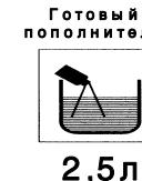
Примечание. Ввиду очень низкого расхода и склонности к окислению, в бак рекомендуется заливать одновременно не более 2,5 л пополнителя.
