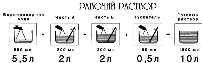
**Примечание.** Крупными цифрами выделены объёмы, необходимые для заливки пополняющих и рабочих баков в наиболее распространённых минифотолабораториях «Фуджи».
