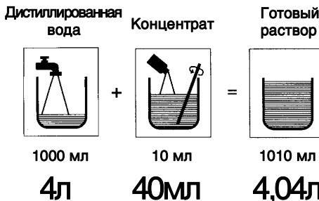
Примечание. Крупными цифрами выделены объёмы, необходимые для заливки пополняющих и рабочих баков в проявочных машинах «Фуджи».
